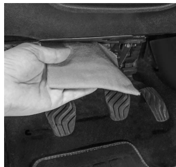
Fig. 2: nettoyer le lieu de montage
